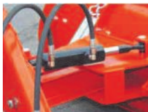
Hydr. Seitenverstellung mit montierten Druckschläuchen
